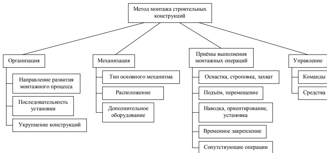
Рис. 1. Дерево целей методов монтажа строительных конструкций
