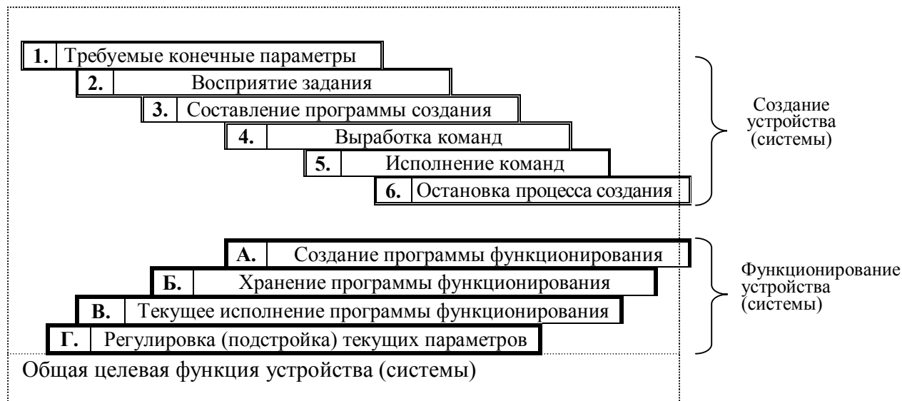
Рис. 1. Основные общие этапы создания и функционирования любого устройства (системы)
